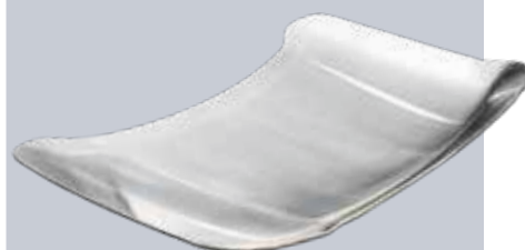
Nickelschalenwerkzeug gefertigt im Galvanobad auf ebablock® P 185
